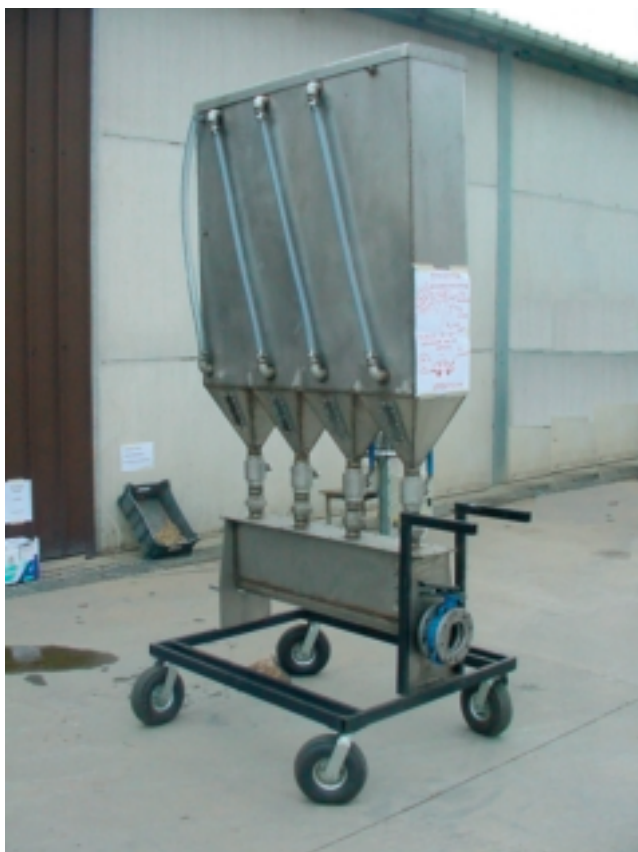
Mobiele filterinstallatie voor oliezuivering op bedrijfsniveau, decantatiebatterij (inhoud 600 liter, 100 x 175 x 270 cm)
