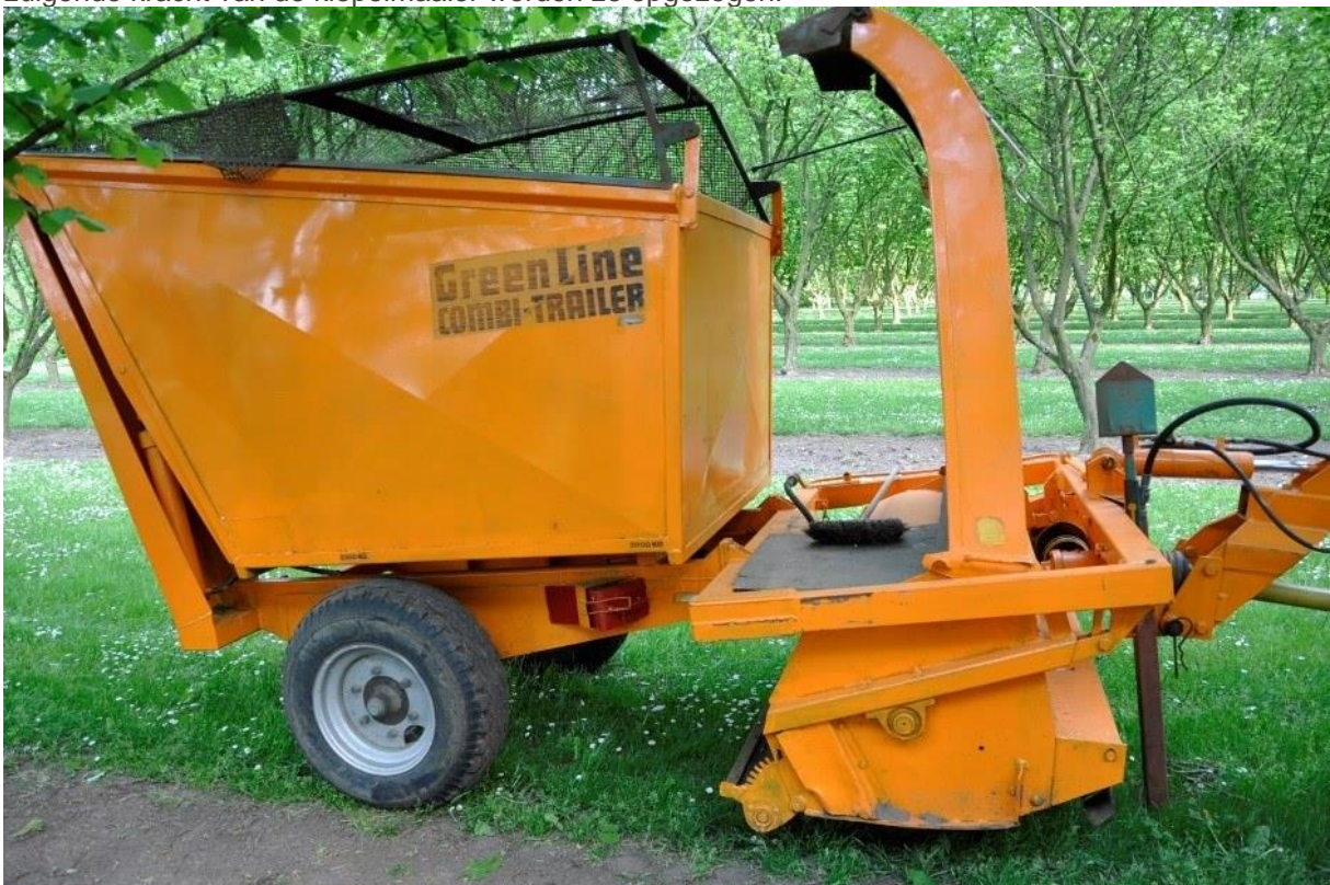
Klepelmaaier met opvangkar om takken en vroegtijdig gevallen hazelnoten te verzamelen.
