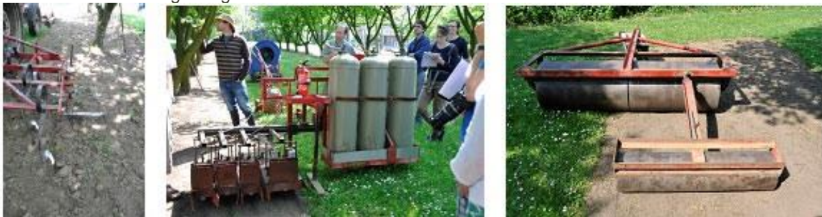
Schoffelmachine en onkruidbrander voor onkruidbestrijding en dubbele rol om het bodemoppervlak mooi te effenen om machinale oogst te vergemakkelijken
