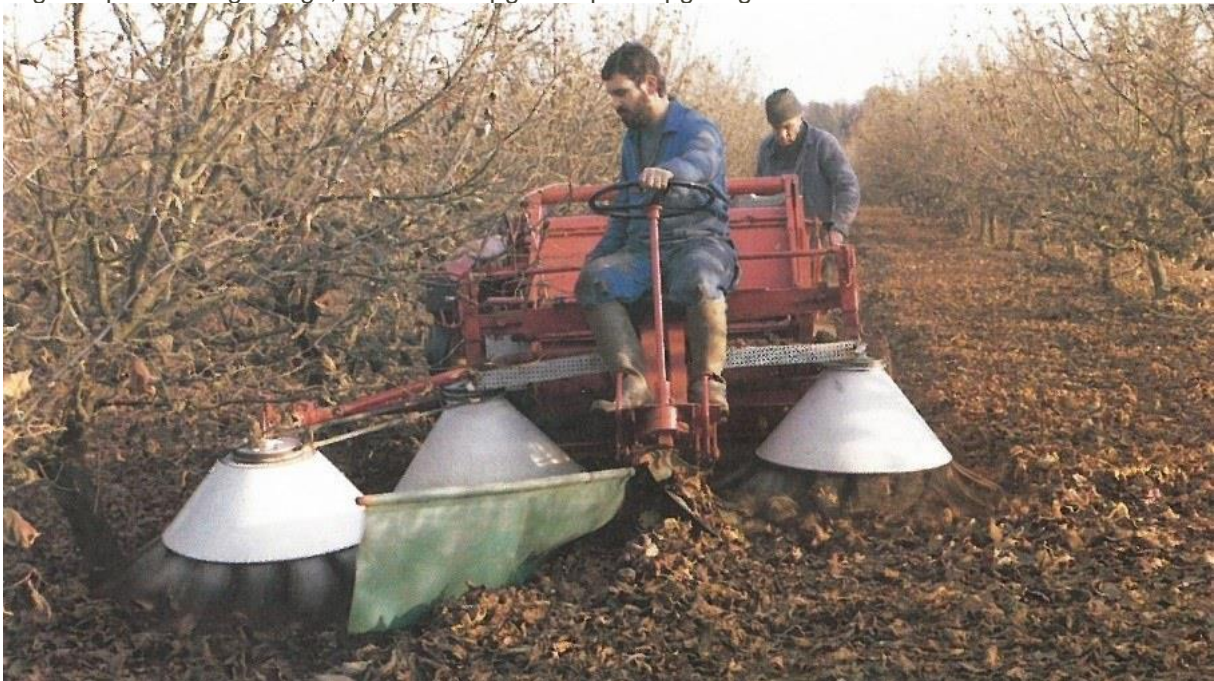
Opraapmachine voor hazelnooten. De noten (en bladeren) worden op stroken geveegd, opgenomen, geschoond en in een fust gedeponerd. Bron; Ets.Cacuevel, S.A.E. Gavray, Frankrijk
